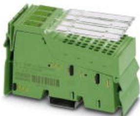
Клеммный модуль аналогового ввода Inline, в комплекте с принадлежностями (соединительный штекер и держатели для маркировки), 8 каналов, TC (термоэлемент), RTD (датчик сопротивления), 2-, 3-проводная схема подключения
