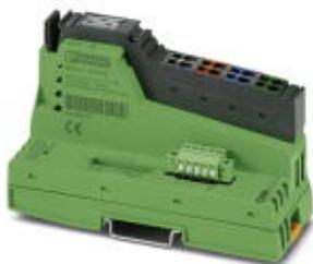
Inline, Устройство сопряжения с шиной, CANopen®, MINI COMBICON, Скорость передачи данных в локальной шине 500 kBit/s / 2 MBit/s, Степень защиты IP20, с сетевым штекером, штекером Inline и полем для маркировки
