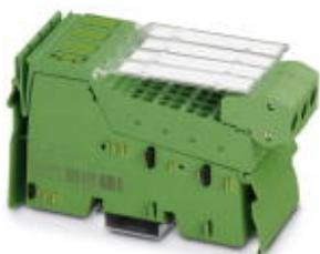
Клеммный модуль аналогового ввода Inline для тензометрических датчиков, с принадлежностями (соединительный штекер и держатели для маркировки), 2 точных и быстрых входа, 4-, 6-проводная схема подключения
